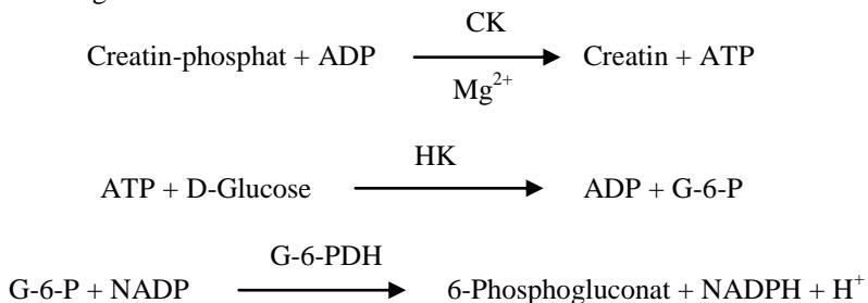
Die Bildung von NADPH wird als Extinktionsänderung bei 340 nm im Verhältnis zu 405 nm bestimmt. Diese Extinktionsänderung verhält sich direkt proportional zur Creatin-Kinase-Aktivität in der Probe.
