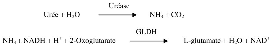
Le taux de variation de la différence d'absorbance entre 340 nm et 405 nm est causé par la conversion de NADH en NAD<sup>+</sup> et est directement proportionnel à la quantité d'urée présente dans l'échantillon.
