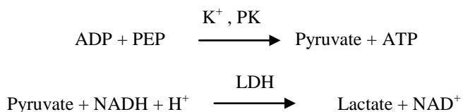
Le taux de variation de l'absorbance entre 340 nm et 405 nm est causé par la conversion de la NADH en  $NAD^+$  et est directement proportionnel à la quantité de potassium dans l'échantillon.
