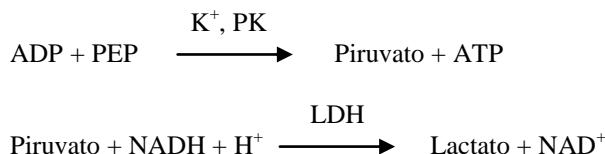
El rango de cambio en la diferencia de absorbancia entre 340 y 405 nm se debe a la conversión de NADH en NAD<sup>+</sup> y es directamente proporcional a la cantidad de potasio en la muestra.
