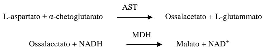
La velocità di variazione nell'assorbanza causata dalla conversione di NADH in NAD<sup>+</sup> è determinata bicromaticamente a 340 nm e 405 nm. Questa velocità è direttamente proporzionale alla quantità di AST presente nel campione.
