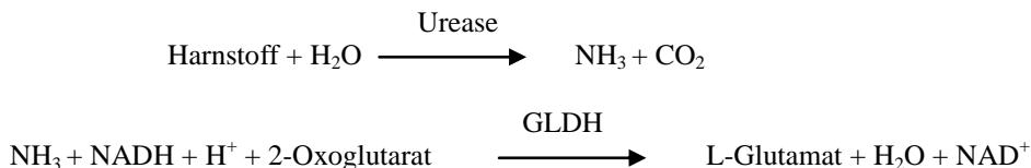
Die Änderungsgeschwindigkeit der Extinktionsdifferenz zwischen 340 nm und 405 nm hängt mit der Umwandlung von NADH zu  $\text{NAD}^+$  zusammen und ist direkt proportional zur Menge des in der Probe vorhandenen Harnstoffs.
