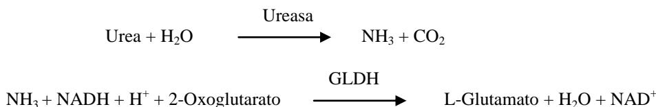
El índice de cambio de la diferencia de absorbancia entre 340 nm y 405 nm se debe a la conversión de NADH en NAD<sup>+</sup> y es directamente proporcional a la cantidad de urea en la muestra. Principios de la operación
