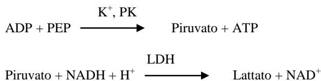
La velocità di cambiamento dell'assorbanza causata dalla trasformazione dell'NADH in NAD<sup>+</sup> è direttamente proporzionale alla quantità di potassio presente nel campione.
